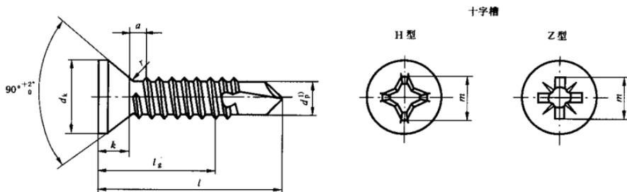
1) 钻头部分(直径  $d_p$ )的工作性能按 GB/T 3098.11 规定。
