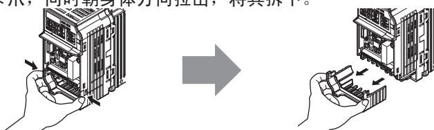
图 3.7 下部外罩的拆卸方法（柜内安装型）
