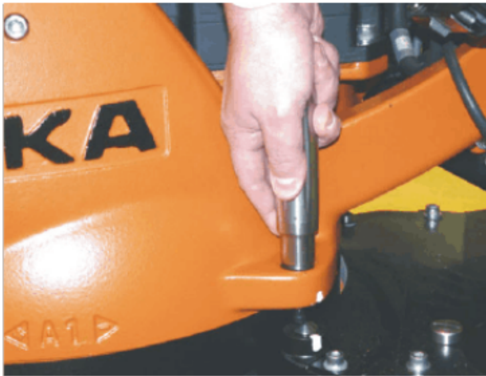
图 5-8: 将 EMD 拧到测量筒上
