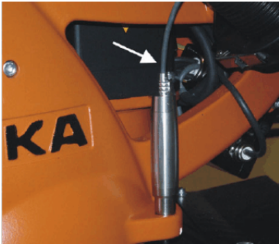
图 5-9: 将测量导线接到 EMD 上
