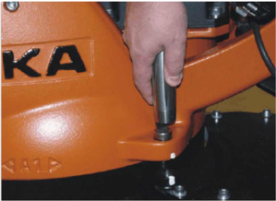
图 5-7: 取下测量筒的防护盖
