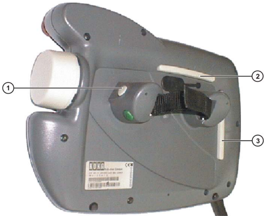
4-5: 库卡控制面板（KCP）上的确认开关
