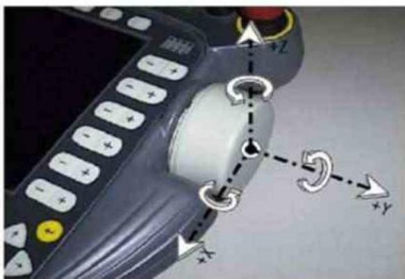
如果你绕X轴旋转手轮，将使刀具中心点同样绕所设定的参照坐标系统的X轴旋转。这同样适用于Y轴或Z轴。
