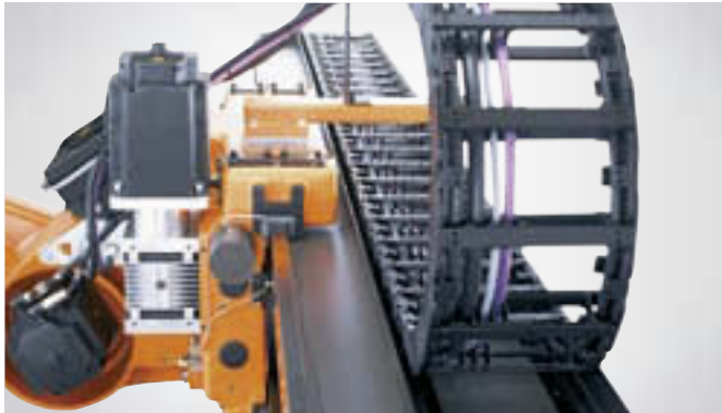
La catena portacavi disposta in modo sicuro sul lato superiore del KUKA JET consente una traslazione senza inconvenienti.
