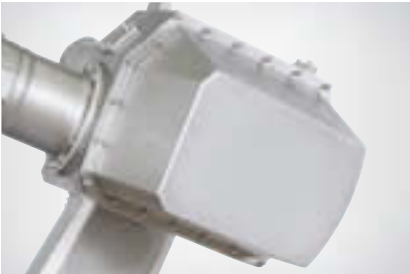
Le recouvrement des moteurs signifie : pas de système électrique ouvert, et donc, un nettoyage sans problèmes.
