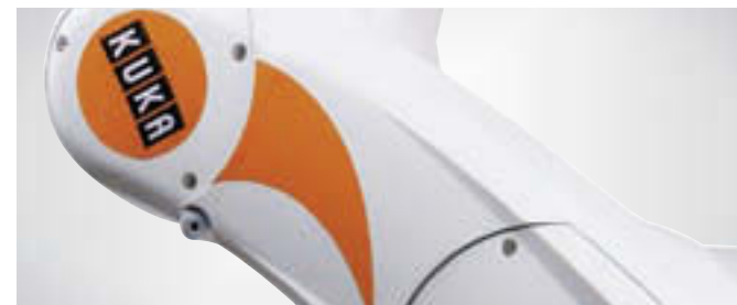
Les recouvrements vissés garantissent une protection optimale des unités d'entraînement.
