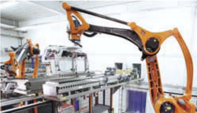
Les robots de palettisation KUKA exécutent toutes sortes de tâches en un tour de main.
