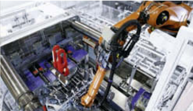
Les robots sur console KUKA sont appropriés de façon idéale pour le prélèvement de pièces hors de presses d'injections.
