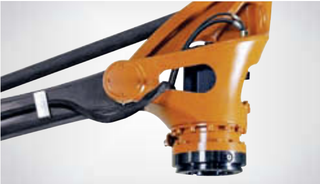
L'utilisation de composants renforcés en fibres de carbone réduit le poids et augmente la performance.
