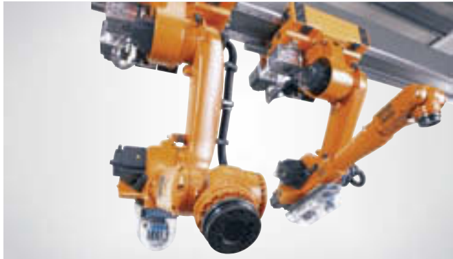
Auf einer JET-Achse können zwei Roboter betrieben werden, womit ein Höchstmaß an Flexibilität garantiert ist.
