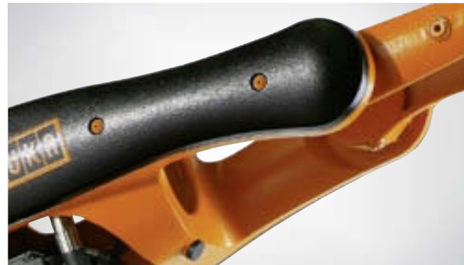
Durchlassöffnung mit 50 mm Durchmesser in Arm und Hand lässt Platz für zusätzliche Medien im Schlauchpaket.
