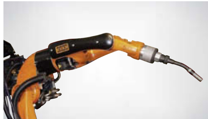
Das optimal geschützte Schlauchpaket ist wesentlicher Bestandteil des Schweißequipments.
