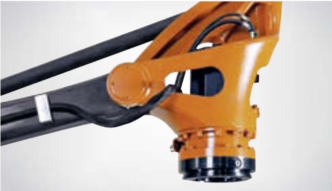
Der Einsatz von kohlenstofffaserverstärkten Komponenten verringert das Gewicht und erhöht die Performance.
