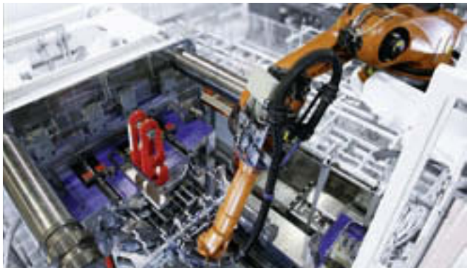
KUKA Konsolroboter sind ideal geeignet für die Entnahme von Teilen aus Spritzgussmaschinen.
