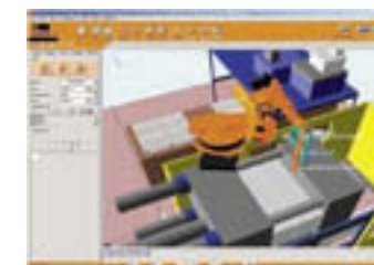
KUKA.Sim ermöglicht originalgetreue Simulation von Roboterzellen.
