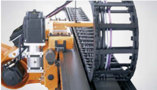
Der sicher verlegte Kabelschlepp auf der Oberseite des KUKA JET, hier in seitlicher Montage, ermöglicht störungsfreies Verfahren.
