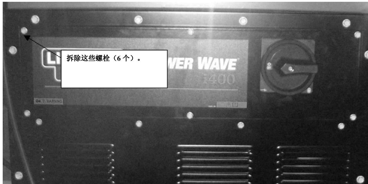
图 9.1.1 (c) 拆除焊接电源的盖罩
