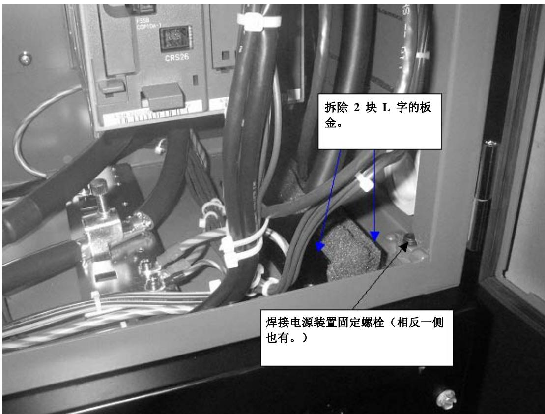
图 9.1.1 (b) 拆除电缆固定板金、焊接电源固定螺栓
