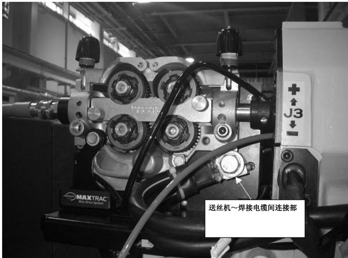
图 2.4 (f) 送丝机的连接接口 (2/2)
