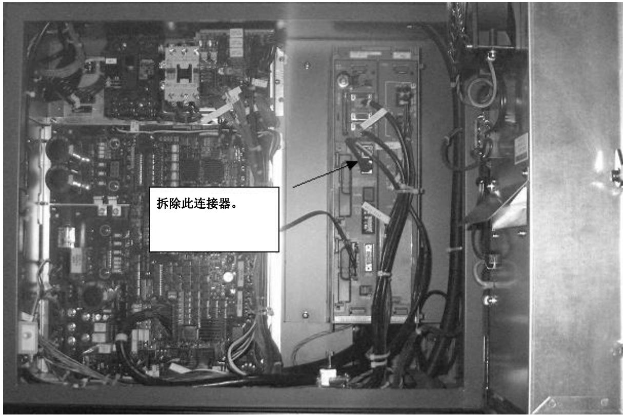
图 9.1.1 (a) 拆除主板的连接器(R-30iA 控制装置 A 机柜)
