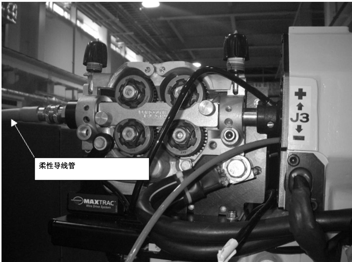
图 9.2.1 (a) 拆除柔性导线管
