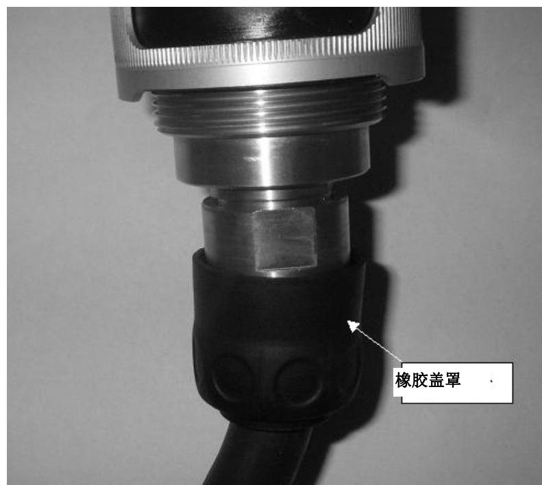
图 9.2.4 (d) 拆除橡胶盖罩
