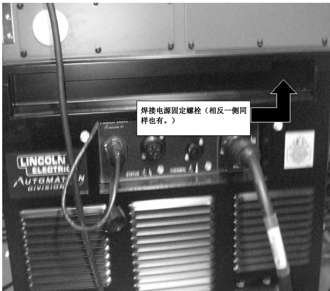
图 9.1.1 (e) 拆除焊接电源固定螺栓
