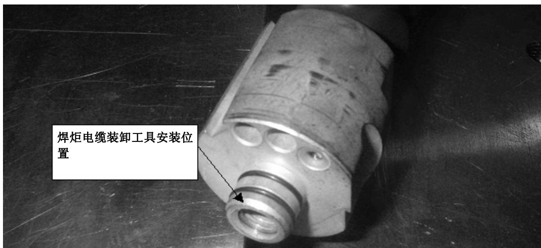
图 9.2.1 (e) 焰电缆装卸工具安装位置
