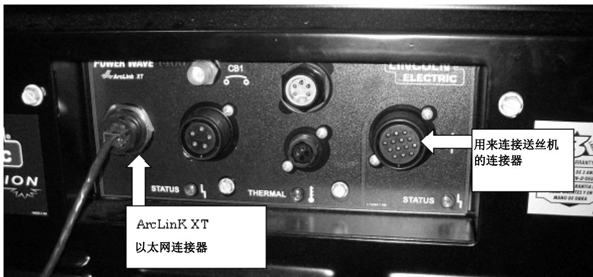
图 2.4 (b) ROBOWELD iC/H 用焊接电源装置(Power Wave i400) 的连接接口
