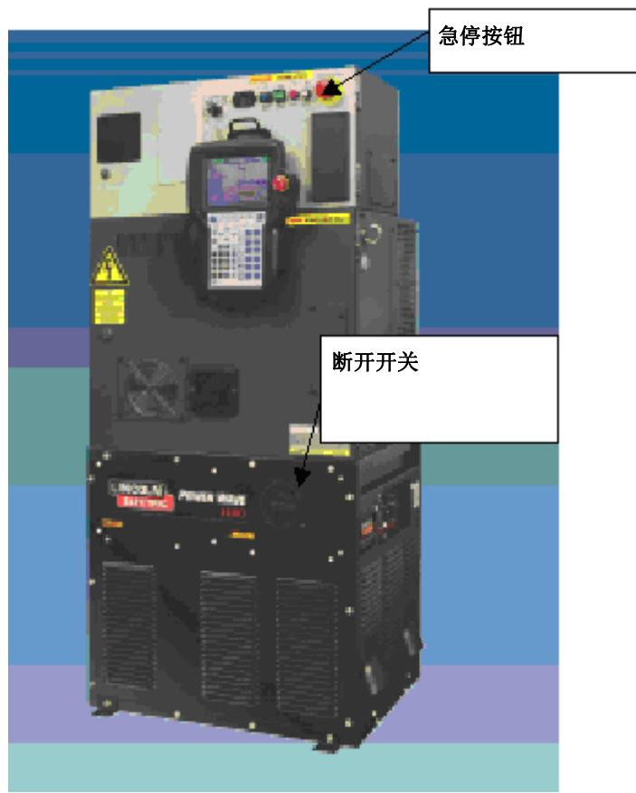
图 2.3 (b) 焊接电源装置一体型控制装置例
