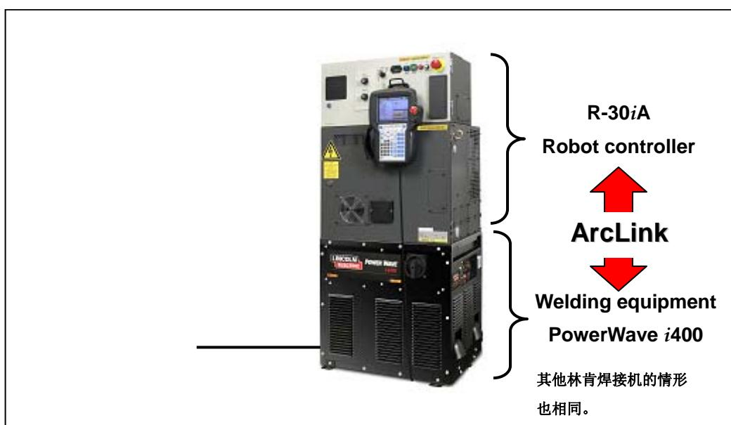
图 3.1.1.4 (a) 有关 ArcLink I/O (例： ROBOWELD 100iC/H )
