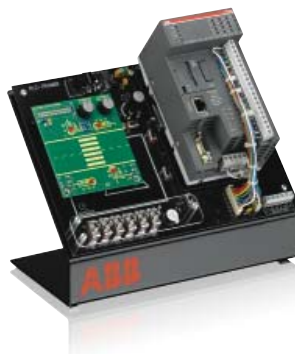
配有交通灯模块的 ABB AC500 PLC 培训包
