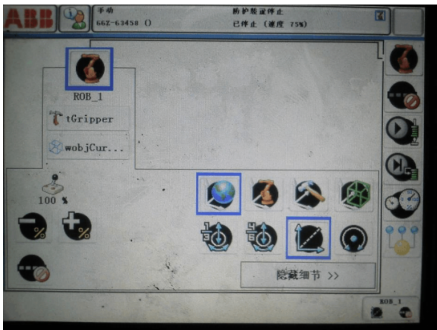
本图选择为 X,Y,Z 坐标系三个方向点动，本模式是使用最多的模式
