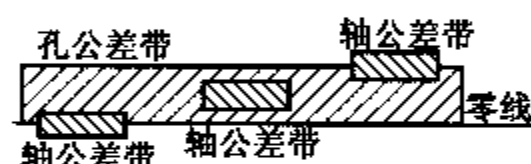
图10 过渡配合的示意图
