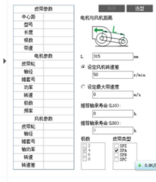
皮带轮选型：风机转速差绝对值为越接近为“0”越好，因此我们选择转速差为“0”的皮带轮。
