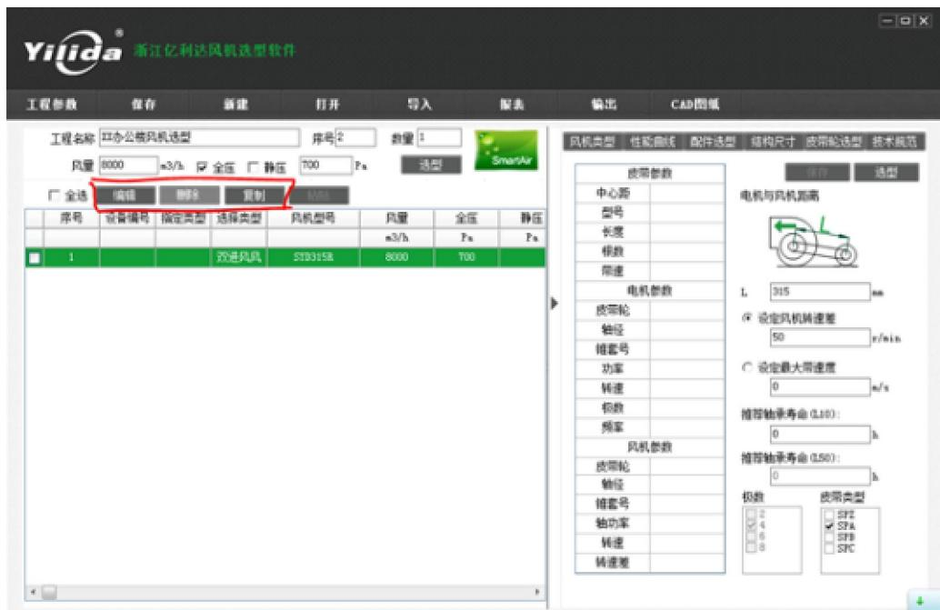
**编辑**：在主界面左侧选中要编辑的风机，双击或点击窗口上方的“编辑”，可进入选型界面进行重新选型。编辑不会改变风机类型。
